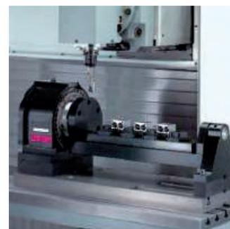
Крепление трех заготовок на траверсе
