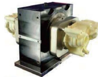
Многосторонняя обработка двух деталей на одной делительной головке
