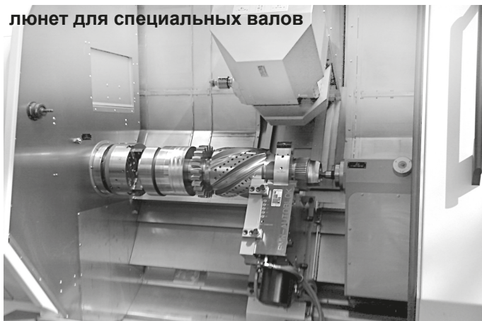
люнет с алмазными опорными сегментами для поддержки первичных валов при тяжелой проточке/шлифовке
