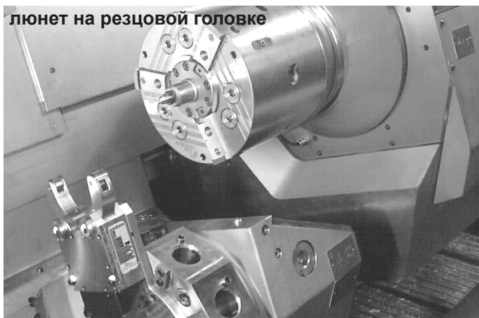
люнет для обработки валов в авиастроении
