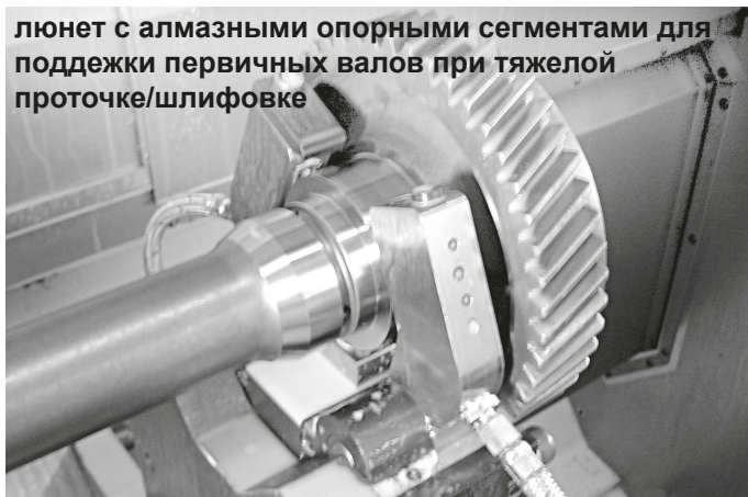
люнет для обработки валов в авиастроении
