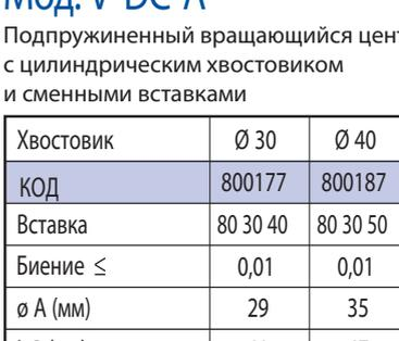
Подпружиненный вращающийся центр с цилиндрическим хвостовиком и сменными вставками
