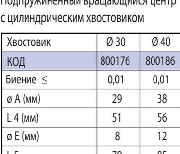
Подпружиненный вращающийся центр с цилиндрическим хвостовиком
